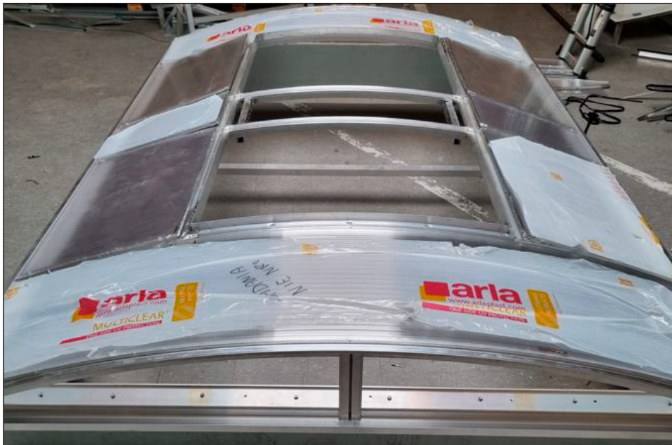
Kuva 9. PC-kennolevyt kiinnitettynä rakenteeseen.
